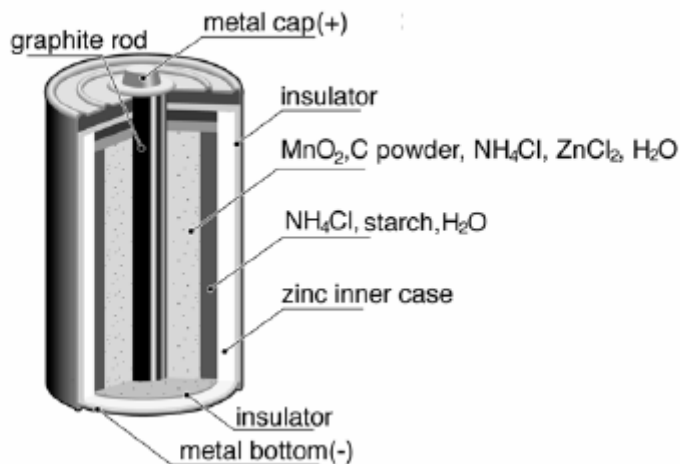
Gambar 10.4 Struktur sel kering mangan. Walaupun digunakan paling meluas, detail reaksi elektrodanya sampai saat ini belum jelas.
